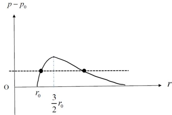
(2) 温度を上げると全体の体積が増えることになるので、平衡状態の圧力を表すグラフ上の水平線の位置は下がる。よって、圧力は低くなる。
